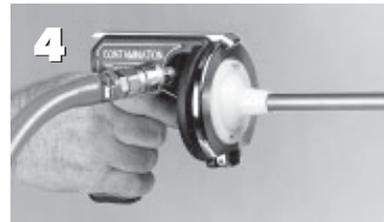
Dann den Düsenhaltering einklinken. Das Mundstück auf die zu reinigende Leitung aufsetzen und den Reinigungsschuss auslösen. Abgeschossene Projektile am Leitungsende aus Sicherheitsgründen und zur Begutachtung des Reinigungseffekts auffangen.
