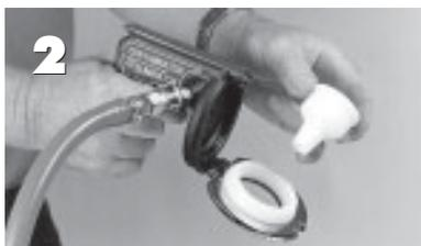
Die für den Rohr- oder Schlauchdurchmesser passende Düse in den Haltering der Pistole einsetzen.
