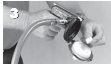
Das für den jeweiligen Reinigungsvorgang geeignete Projektil mit der gemäss Berechnungstabelle ermittelten Dimension in das Mundstück der Düse einführen.
