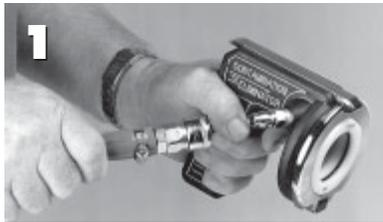
Die Abschusseinheit (Pistole) an einen Kompressor oder eine Druckluftflasche anschliessen.
